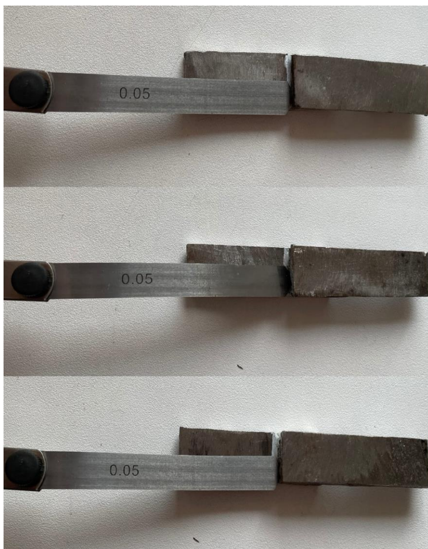
Рисунок 74 – Измерение толщины клеевого шва подготовленных для испытаний образцов
