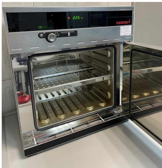
Рисунок 68 – Подготовленный к работе тепловой шкаф Memmert UNB 200
