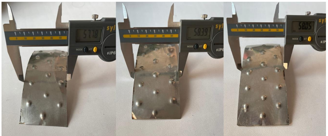
Рисунок 66 – Общий вид и размеры пластин по ширине после формообразования
